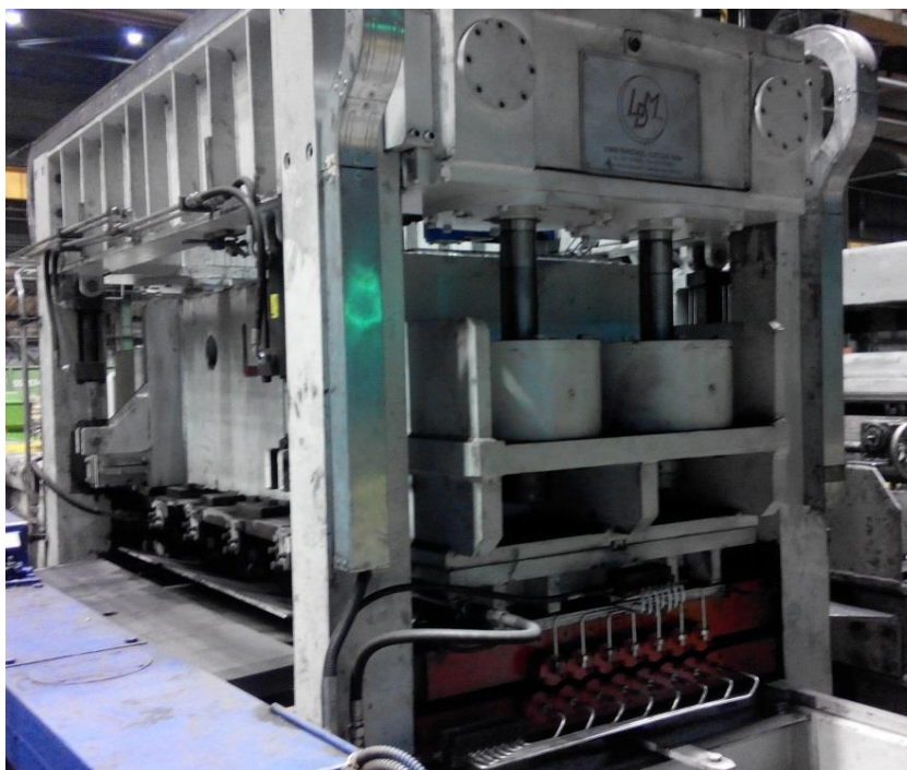
Рисунок 2.1 – 15-роликовая правильная машина агрегата поперечной резки №3
