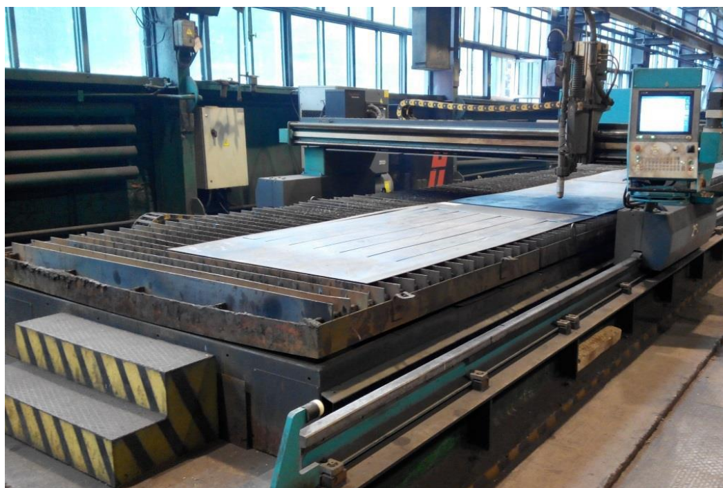
Рисунок 2.3 – Машина плазменной резки SatroniK LS3000
