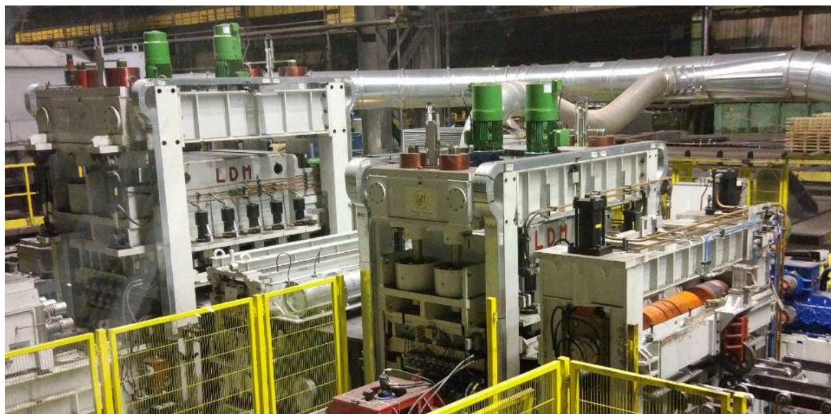
Рисунок 2.2 – 13- и 17-роликовые правильные машины агрегата поперечной резки № 4
