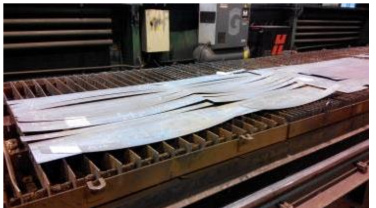
Рисунок 3.24 – Деформации полосок после плазменной резки листов
